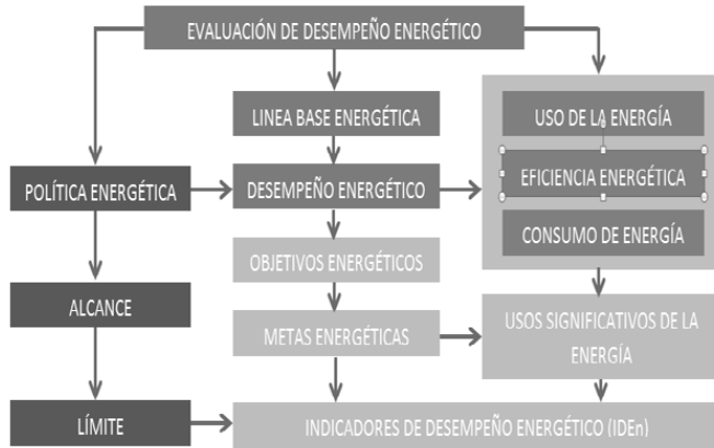
Figura 3. Elementos esenciales de un SGEn y su interrelación
